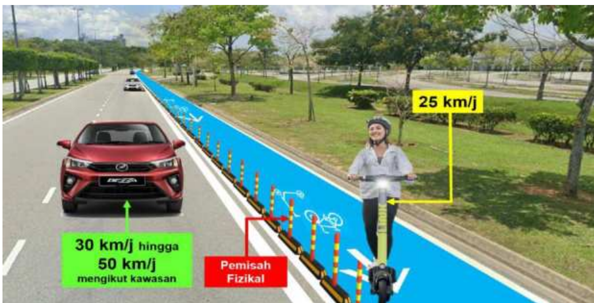
Foto 6: Laluan khas on-carriageway dengan pemisah fizikal bagi mengasingkan kenderaan mikromobiliti dengan kenderaan bermotor lain
