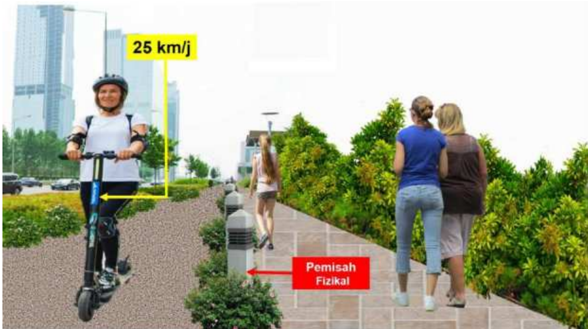
Foto 3: Laluan khas off-carriageway dengan penyediaan pemisah fizikal bagi mengasingkan kenderaan mikromobiliti dengan pejalan kaki
